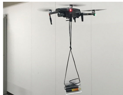
図 3 Raspberry pi を搭載したドローン Fig. 3 Drone with Raspberry pi.
