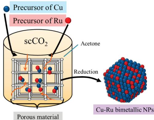
図2 本研究で提案するバイメタルナノ粒子触媒の合成法
