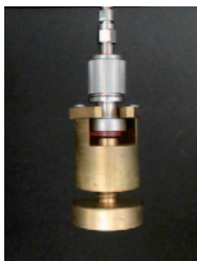
図2. 本研究で作成した光学結晶を参照物質として測定するための治具。
