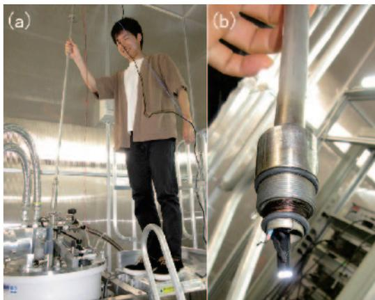
図 5. 反磁性浮上観測用試料ホルダー。LED、カメラ、熱電対、ヒーターを備える。
