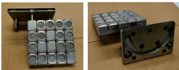
Fig. 9 たんぽぽ2曝露パネル（たんぽぽ2チーム）左：20個の異なる試料がセットされており、うち5個に本実験で準備したアミノ酸薄膜試料がセットされている。右：別角度から撮影した曝露パネル。正面の目盛りは温度計
