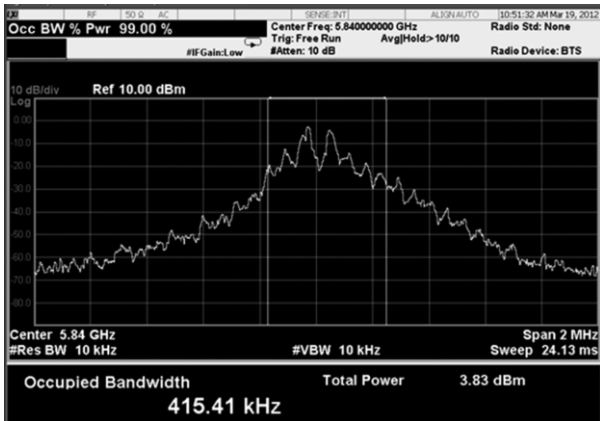
図24：5.84GHz, 115.2kbps FSK のスペクトル
