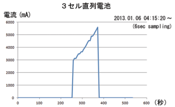
図52：LED 点灯時の電流変化
