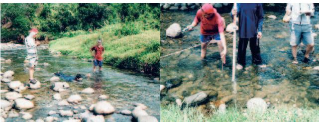
Fig.2 潜水目視 (左) と流速測定 (右)
