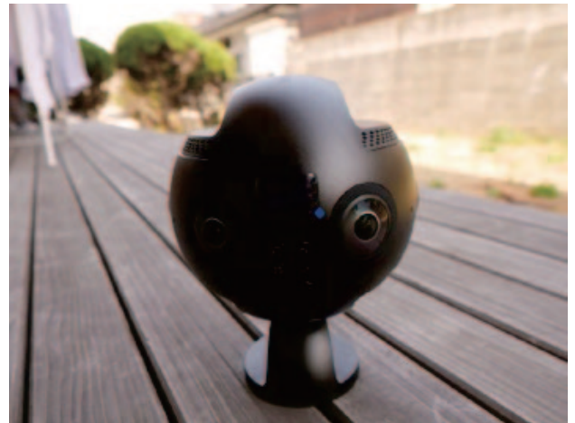
図2 Insta360 Proの外観。レンズは6個である
