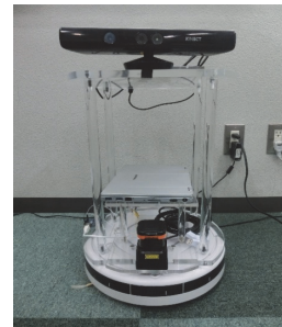
図 5 Kinect と LRF を搭載した移動ロボット Fig. 5. Mobile robot with a Kinect and a LRF.
