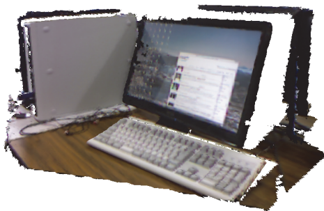
図 2 Kinect Fusion で作成した三次元モデル Fig. 2. 3D model created using Kinect Fusion.
