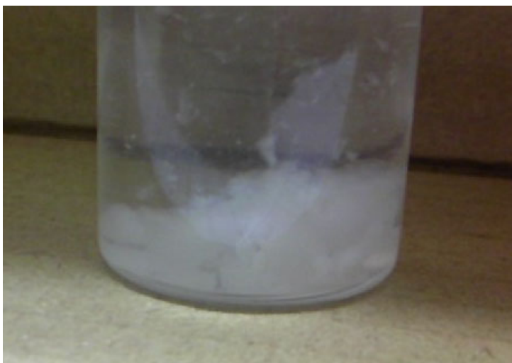
Figure 2-8 MPS/NIPA 比が非常に大きい場合に重合反応後得られた白いフレーク状の物体の写真
