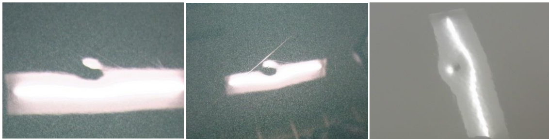
(a)緑色ボンネットの凹み (b)緑色ボンネットの微小凹み (c)白色フェンダーの凹み
