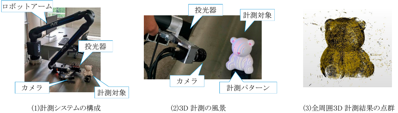
図2 本研究の全周囲 3D 画像計測機及び計測実験結果の一例
