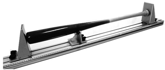
図1 バット重心位置測定器の支点でつり合う位置を測定する際の様子
