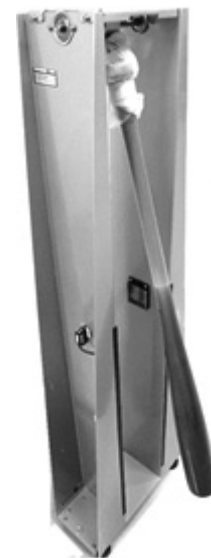
図2 振幅時間測定器を用いて、バットのグリップエンドを固定した状態で、バットの振幅時間を測定する際の様子
